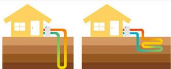
垂直「埋設型」 水平「埋設型」
